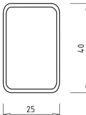
Армирование для трубы ПФХ (экрное соединение)
