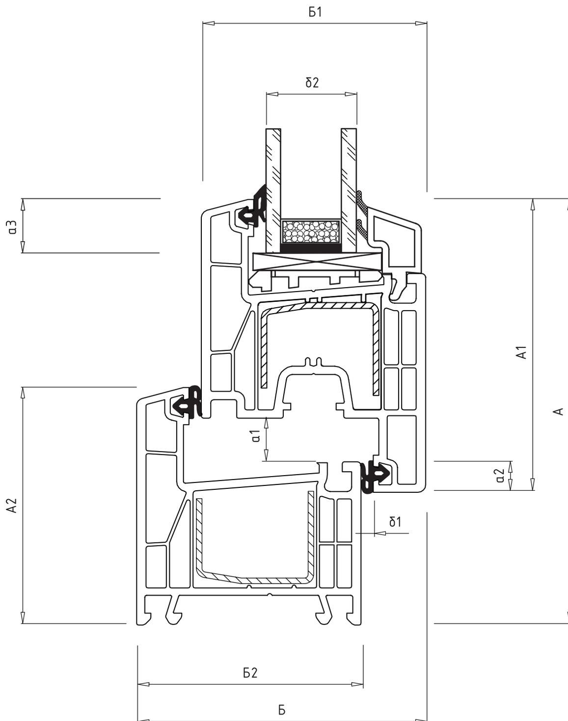
А - высота комбинации профилей; А1 - высота профиля створки; А2 - высота профиля коробки;
