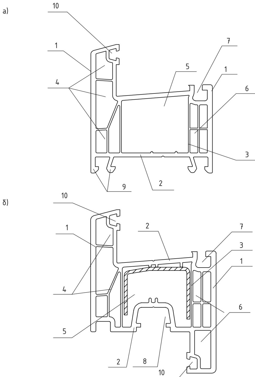
а) - поперечное сечение профиля коробки; б) - то же, створки
